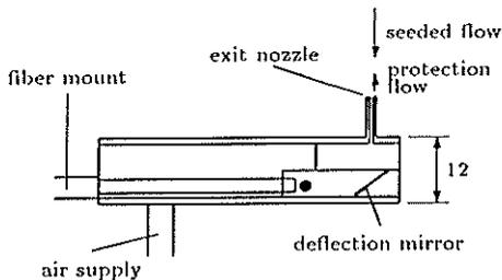
Figure 4: Light-Sheet-Probe, inside mount
